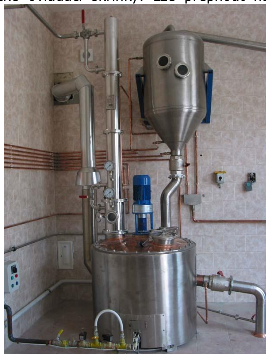
Plynofikace nerezové kotliny s kolonou (DESTILA Brno)
